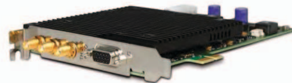
TimeHarp 260 – это компонент TCSPC выполненный в виде платы PCIe с ультракоротким мертвым временем. Благодаря расширенному диапазону до нескольких секунд, его можно использовать для изучения как флуоресценции, так и фосфоресценции.
