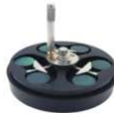
Оправка для загрузки/выгрузки образцов (показана с держателем 5-3461)
