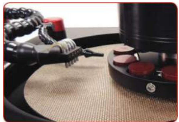
В удобном поворотном манипуляторе с форсунками предусмотрены насадки из нержавеющей стали, которые легко снимаются для очистки
